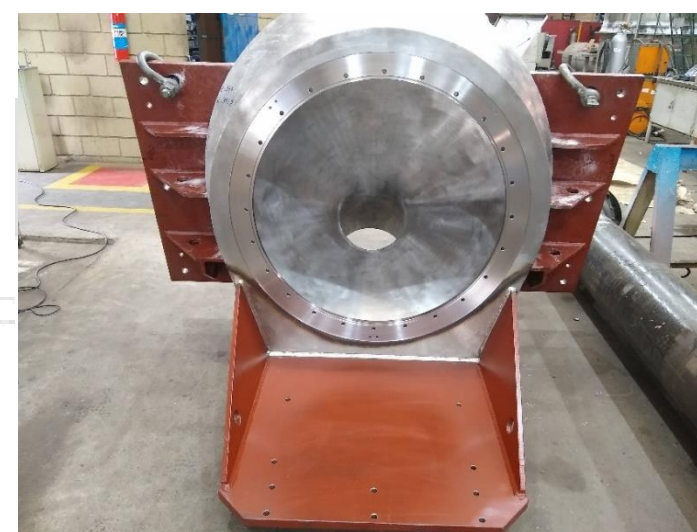
RESERVATÓRIO ACABADO APÓS USINAGEM TAMBÉM REALIZADA NA PROFER.
