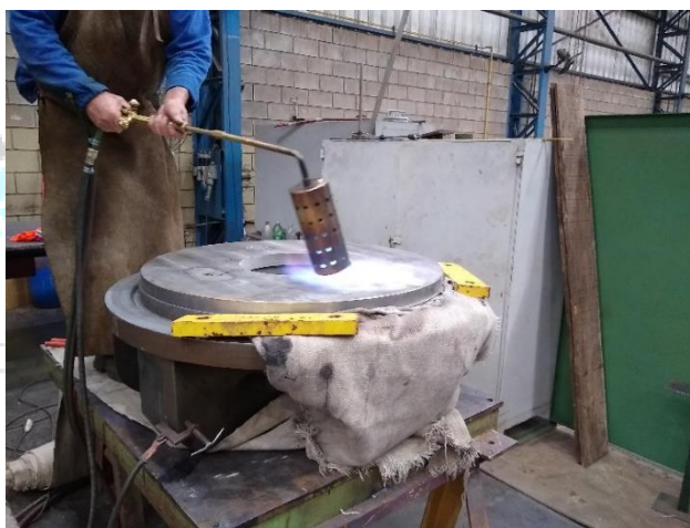
PRÉ AQUECIMENTO E PROTEÇÃO COM MANTA TÉRMICA.
