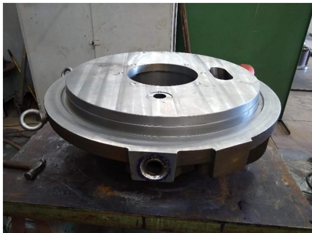
TAMPA USINADA PARA PREPARAÇÃO DA SOLDAGEM
